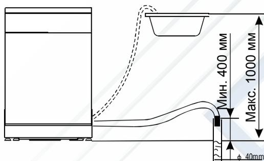
Сливной шланг подсоединяется к сливной водопроводной трубе диаметром не менее 4 см либо выводится в кухонную мойку. Следите, чтобы шланг не сгибался и не перекручивался. Используйте специальное опорное колено (кронштейн) из комплекта поставки. Сливная горловина должна располагаться на высоте от 400 до 1000 мм. При этом ее нельзя погружать в воду во избежание обратного засасывания.
